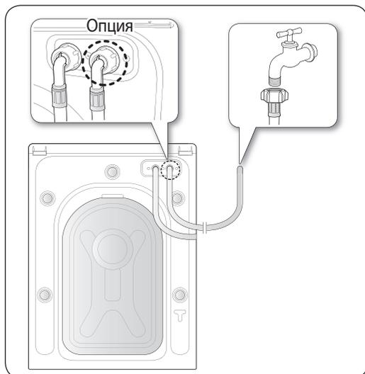
1. Возьмите шланг подачи холодной воды с Г-образной насадкой и подсоедините его к входному отверстию подачи холодной воды на задней панели машины. Затяните соединение вручную.
