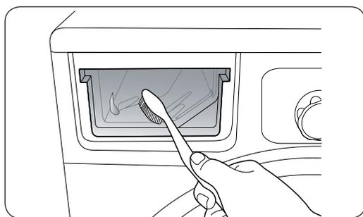
1. Нажмите освобождающий рычаг, расположенный внутри дозатора, и извлеките дозатор.
