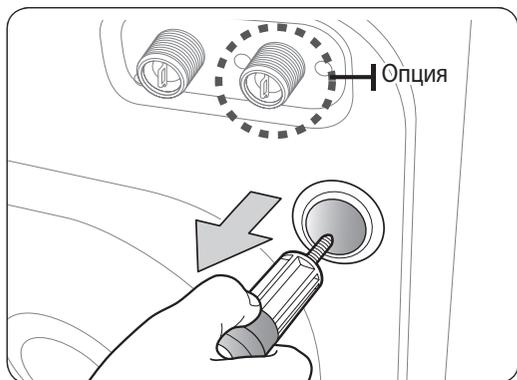
Перед установкой стиральной машины необходимо удалить пять транспортировочных болтов на задней панели устройства.
