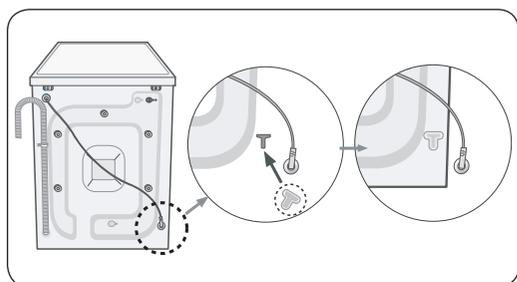
3. Закройте отверстия с помощью прилагаемых пластмассовых заглушек.
