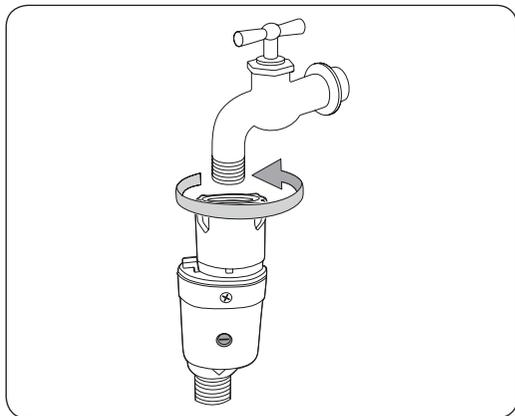
Шланг Aqua специально разработан для защиты от утечки воды. Он подключается к шлангу подачи воды и автоматически перекрывает поток воды в случае повреждения шланга. На нем также есть предупреждающий индикатор.
