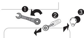
**ВНИМАНИЕ!** Транспортировочные болты вставлены во втулки. Болты необходимо удалить вместе со втулками таким образом, чтобы втулки не попали внутрь машины.
